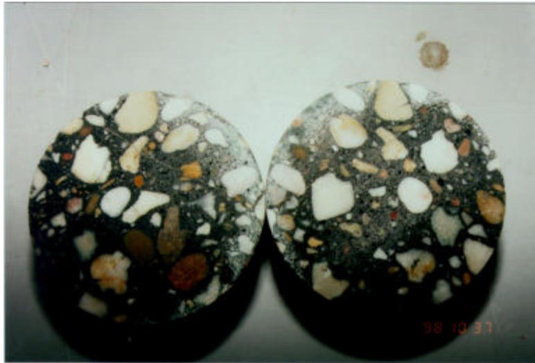
**Abb. 6:** *Ergebnis über eine Kontrollbohrung – zur besseren Kontrolle wurde der Bohrkern in Scheiben geschnitten nach einer erfolgreichen Injektion mit Zementsuspension. Selbst Risse mit Eingangsrißbreiten von 0,1 mm waren vollflächig verfüllt.*
