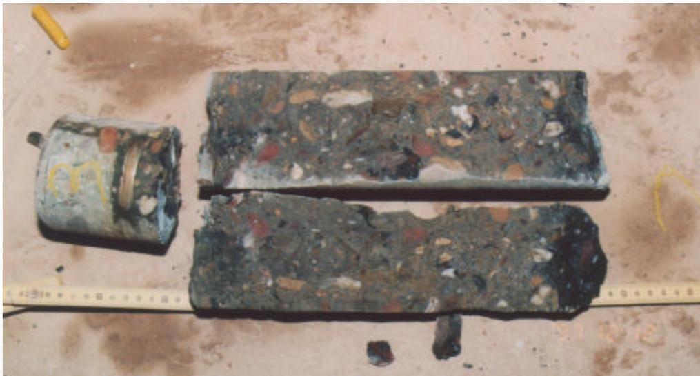
**Abb. 5:** *Ergebnis über eine Kontrollbohrung nach einer nicht erfolgreichen Injektion. Es wurde keine Zementsuspension in den Rißflächen vorgefunden. Der Bohrkern fiel nach der Entnahme auseinander.*
